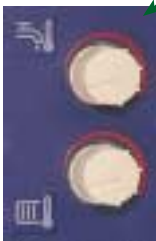
Drejeknapper for regulering af brugsvand og varmekredse.
